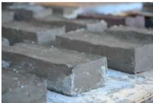
Fabrication d'élément de masse issue de sédiments aqueux (ou utilisation de matériaux à changement de phase, bio-sourcés)
