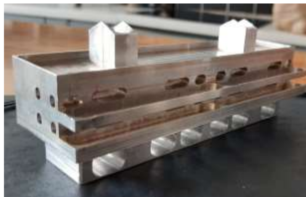
Usinage 5 axes de bâtiments
